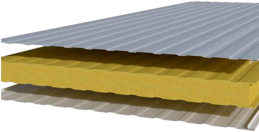
Mediante un panel sándwich de 40 mm formado por chapa prelacada blanca 0,5mm, aislamiento interior de poliuretano inyectado de densidad 40 kg/m<sup>3</sup> y juntas térmicas de PVC rígido + caucho entre uniones de paneles, logramos una estructura que aísla térmica y acústicamente del exterior nuestros módulos prefabricados..
